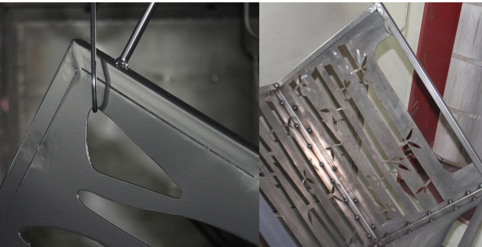
La chapa por si sola no tiene rigidez, ya sea espesor 0,9mm o 3,2mm.
